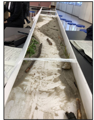
図8 プラスチックダンボールを使用した流水実験機例
