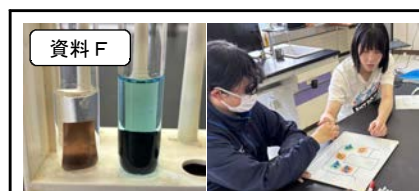
資料F 「イオン化傾向」硫酸銅水溶液に亜鉛板を入れる実験で銅が発生するしくみをイオンモデルで考える。水素の発生を考えた経験が活かしてスムーズにしくみを考えることができた。
