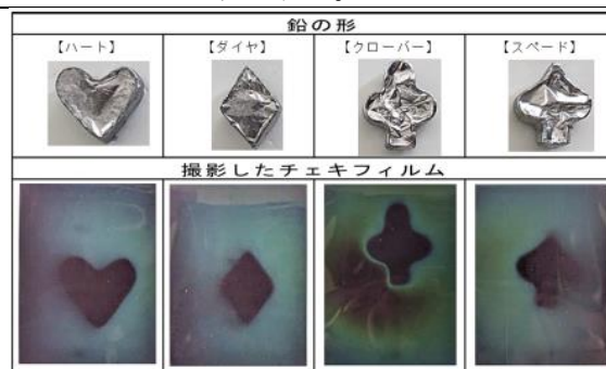
図９ 放射線を可視化する撮影実験
