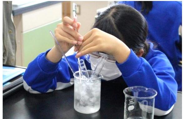
図6 水溶液の凝固点を調べる様子
