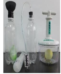
写真17 水圧実験器 写真18 大気圧実験器
