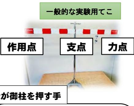
御柱のてこ棒に対応した実験装置を用意し，てこ棒を使って御柱を動かすてこのはたらきを，子どもが実験によって数値化して検証し一般化できるようにした。
