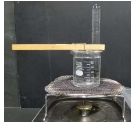
倒立した試験管（中は水で満たしている）で泡を捕集する
