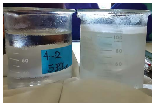
冷却により氷になったビーカー内の水 （ビーカーを用いたため破損している）
