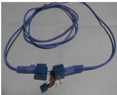
接続部を改造したLANケーブル 説明のため接続部を開いた写真
