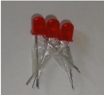
足の長短を合わせて、発光ダイオードの足を束ねる。
